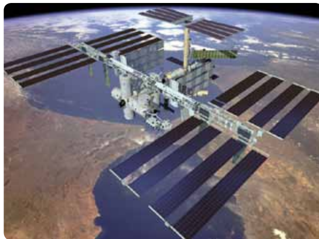
Fotovoltaika na vesmírné stanici ISS
